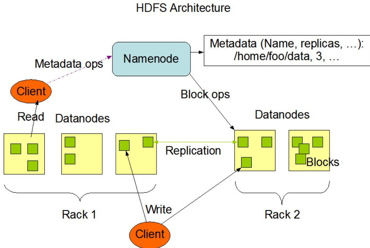
Namenode和Datanode被设计成可以在普通的商用机器上运行。这些机器一般运行着GNU/Linux操作系统(OS)。HDFS采用Java语言开发，因此任何支持Java的机器都可以部署Namenode或Datanode。由于采用了可移植性极强的Java语言，使得HDFS可以部署到多种类型的机器上。一个典型的部署场景是一台机器上只运行一个Namenode实例，而集群中的其它机器分别运行一个Datanode实例。这种架构并不排斥在一台机器上运行多个Datanode，只不过这样的情况比较少见。
